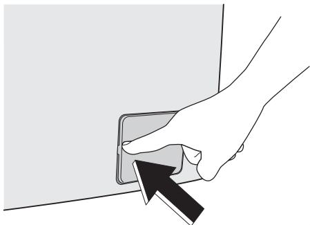
**ВНИМАНИЕ!** При работающем приборе в зависимости от выбранной программы в сливном насосе может быть горячая вода. Никогда не снимайте крышку сливного насоса во время стирки, всегда дожидайтесь, чтобы прибор завершил цикл и спил воду. При установке крышки на место убедитесь, что она плотно затянута во избежание утечек и возможности снятия ее детьми.
