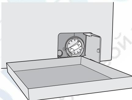
5. С помощью плоскогубцев выньте заглушку отверстия аварийного слива из крышки фильтра.
