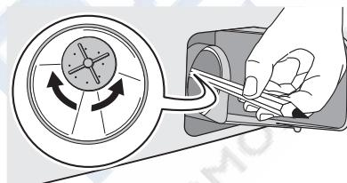
9. Вставьте фильтр в правильном положении, используя специальные направляющие. Плотно закрутите крышку насоса, вращая ее по часовой стрелке.
